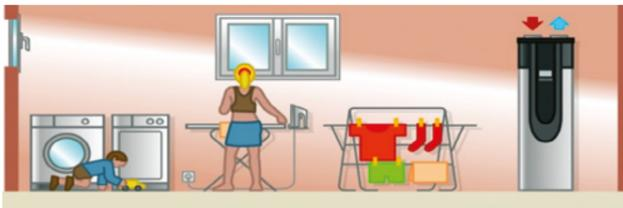
Le coefficient de performance (COP) est déterminant, il doit être supérieur à 3 pour être efficace et respecter la réglementation et c'est souvent lui qui détermine le choix d'un ballon thermodynamique indépendant du système de chauffage donc individuel, ou qui intègre l'eau chaude et le chauffage.
